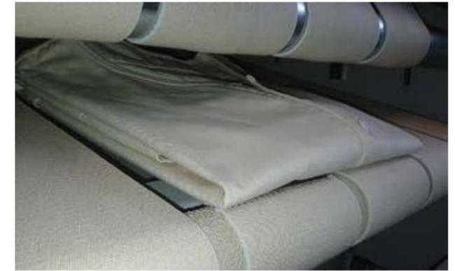
de plantillas plegables, chorros de aire (AG220) o con cuchillas (MG200). La medición de cada elemento combinada con una gran sección de pliegue primario permite a los operarios procesar lotes mixtos que contienen una amplia gama de tamaños.
