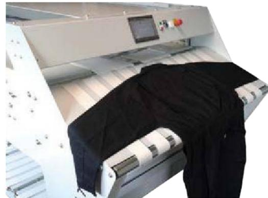
Una vez que una pila alcanza su altura predeterminada, la unidad la transfiere directamente a una cinta transportadora de entrega final ubicada en el lado izquierdo o derecho de la unidad y la entrega a la parte delantera o trasera de la máquina.
