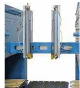
Dispositif anti-basculement pour les machines jumelées.
