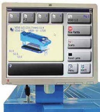
Application de surveillance pour l'affichage de l'état de la machine. Client/article en production, programme, données de production.
